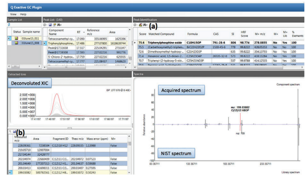
图 5. 保留时间为 17.49 min 的色谱峰被鉴定为三苯基氧化膦。本图为 TraceFinder 软件中解卷积数据与谱库匹配的界面截屏。(a) 按照评分 (SI 与 HRF 综合) 排序的谱库匹配结果。(b) EI 质谱图中的碎片离子列表以及相应的最佳元素组成结果。
